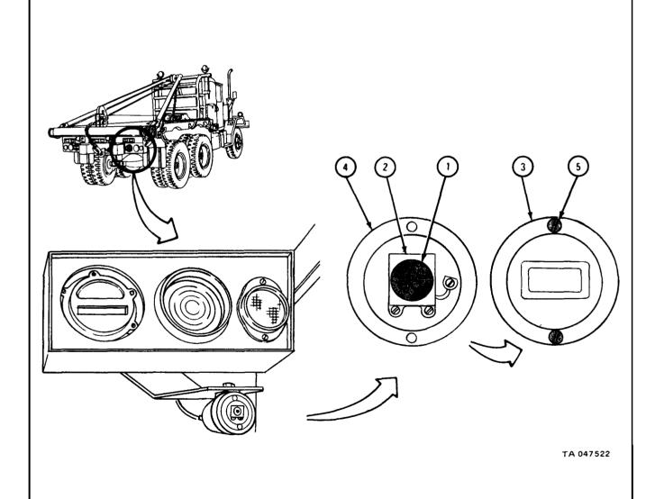
7-33. BLACKOUT STOPLIGHT ASSEMBLY (RIGHT SIDE ONLY) REPAIR.
